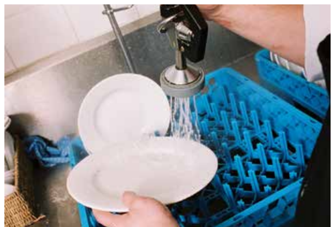
節水式の高性能なリンスバルブを使用することも、1つの節水方法です。
